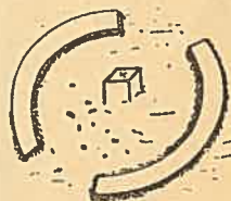
Légifényképezés céljára vízszintes alappontok gipsz jelölései
