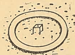
Légifényképezés céljára vízszintes alappontok gipsz jelölései
