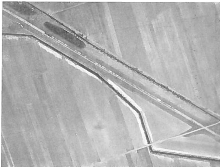
Egyvágányú vasút töltésen, rajta vonat, egyik oldalon szabályos csatorna, melynek két oldala feltöltött. A csatornát és a vasutat egy talajút keresztezi. A vasúti kereszteződésnél egyenletesen emelkedő feljáró van, a vasút másik oldalán keskeny árok látható bokrokkal
